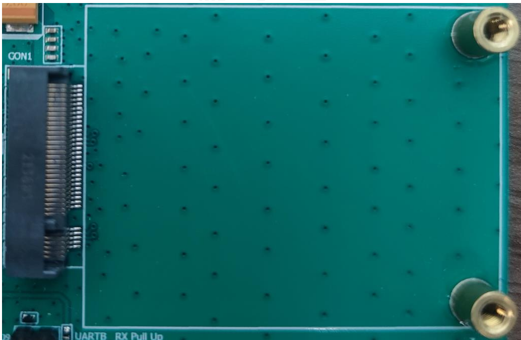
图 2.3 开发板 M.2 Key B 接口图
